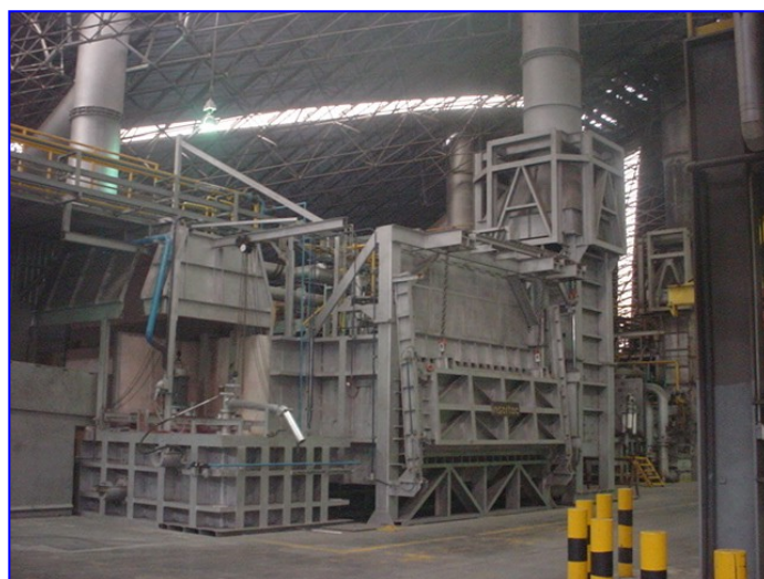
Horno estático HIRARO con 70 Mton de capacidad de metal y 8 ton/hr de ratio de fusión
