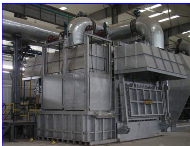
Horno estático HIRARO de 35 Mton capacidad
