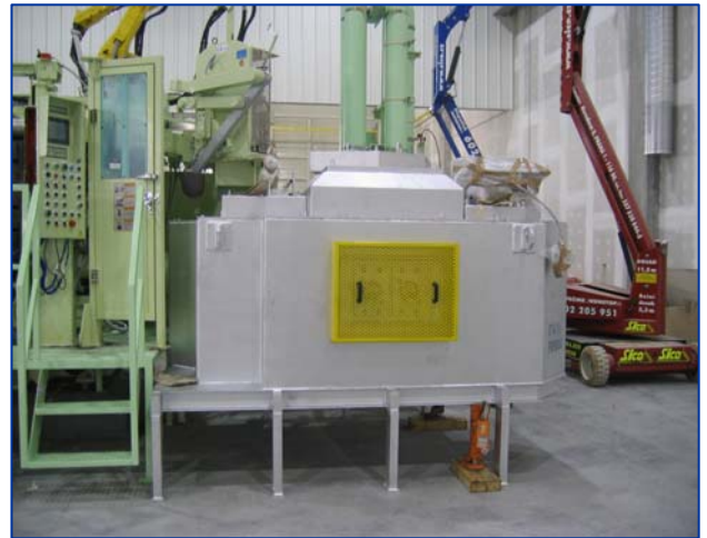
Horno de Mantenimiento IMAE situado a pie de máquina de colada
