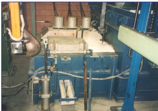
Rotor desgasificado, calentadores verticales y tapa de pozo colada con accionamiento neumático
