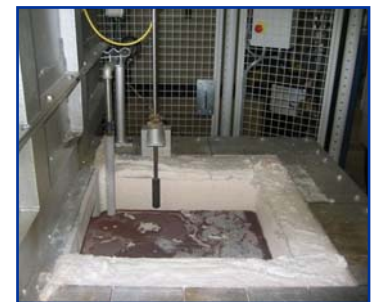
Detalle pozo colada termopar y sensor nivel de baño
