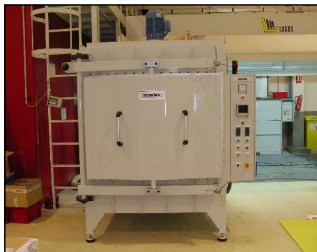
Horno de Recirculación tipo Cámara con puerta frontal de bisagra (Diseño compacto).
