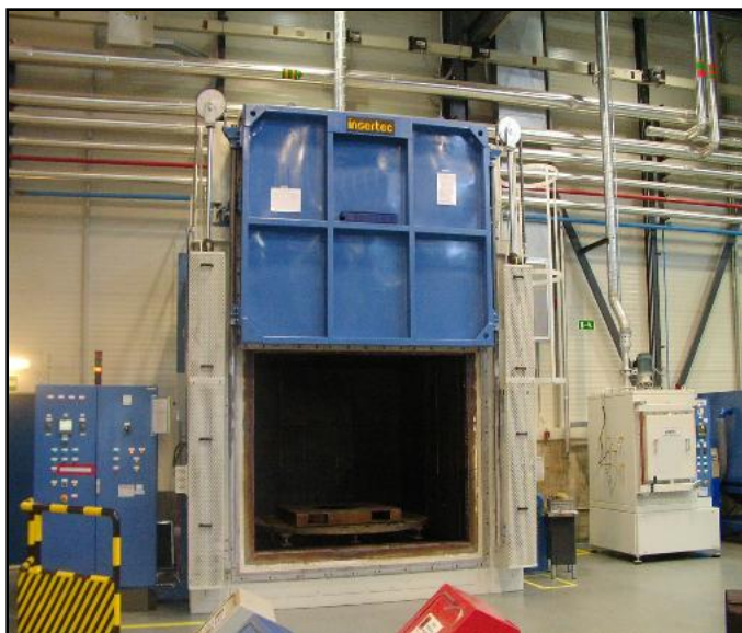
Distintos Hornos de Recirculación tipo Cámara.
