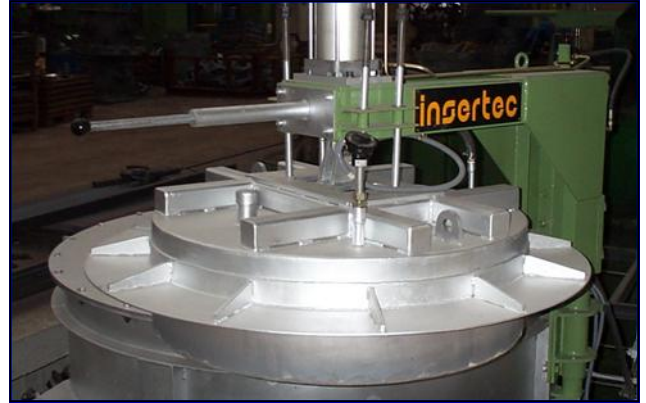
Horno de pote, detalle de la tapa de cierre.
