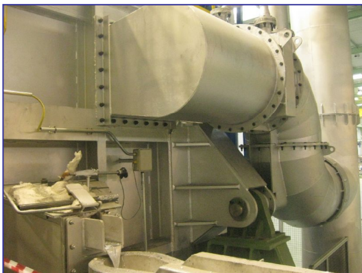
Detalhe da bica alinhada com o eixo de basculação e saída de gases.
