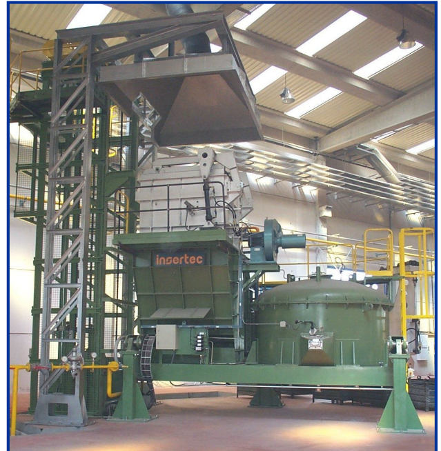
Vista geral forno MELTOWER® basculante com elevador e coifa de captação de gases de combustão
