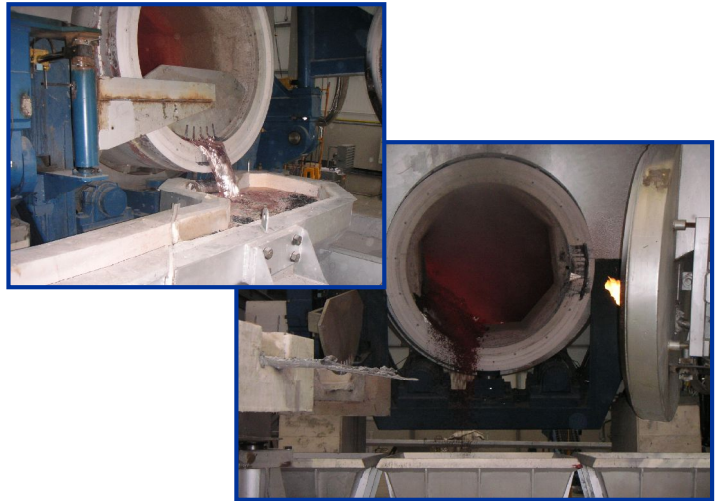
Forno FARB® , com a porta aberta e extraindo escória salina em carro de cestas.
