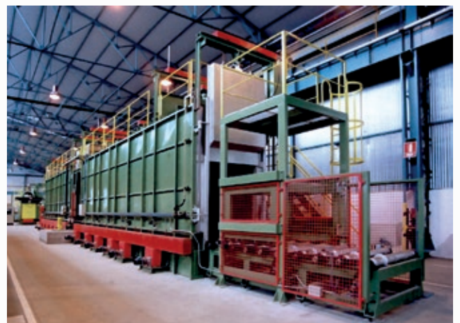
\ Vista general Instalación tratamiento térmico T6 en disposición tipo "U".
