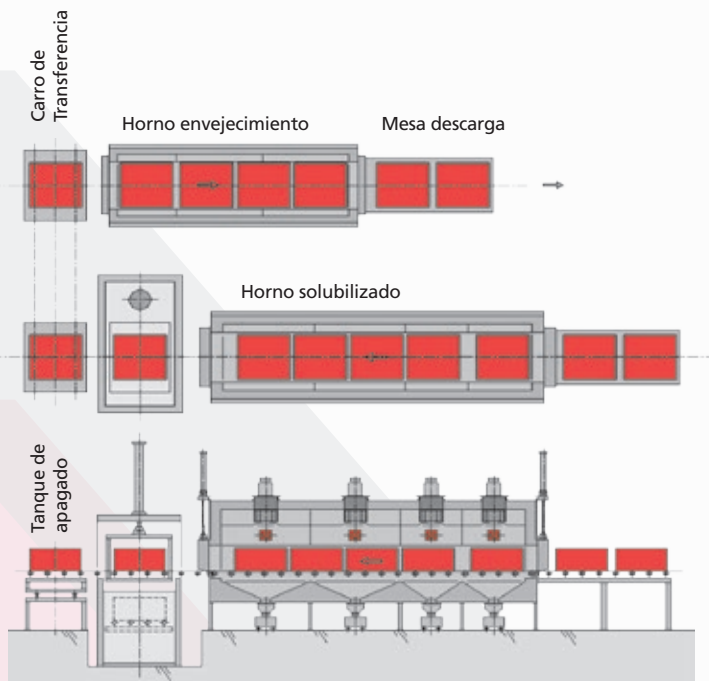
\ Lay-out Instalación T6 en disposición tipo "U"
