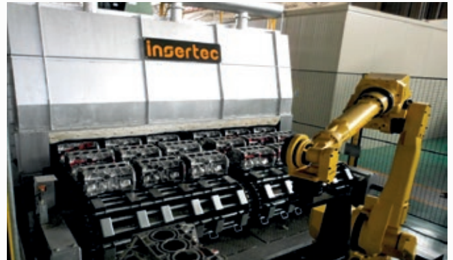
\ Instalación tratamiento térmico T5 basketless provista de robot de carga.
