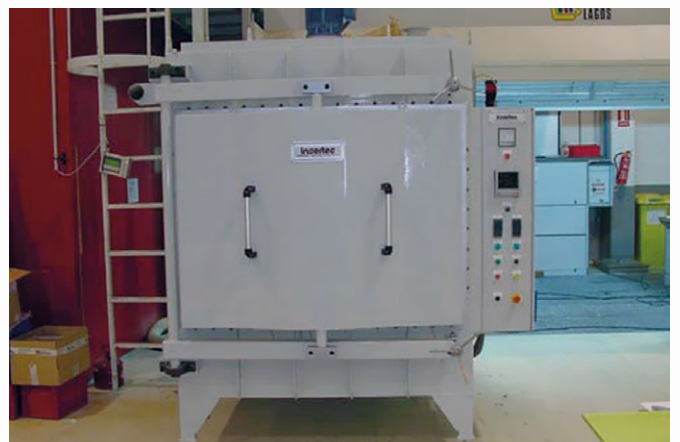
\ Horno de recirculación tipo carro con puerta frontal de guillotina.
