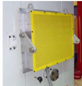
\ Detalle de montaje elemento calefactor con acceso desde exterior del horno.
