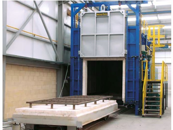
\ Horno de recirculación tipo carro con puerta frontal de guillotina.
