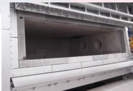
\ Precast shapes door frame
